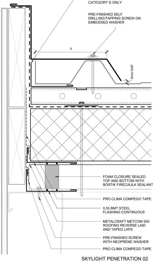
UNDERSOAKER FLASHING REQUIRED FOR NZ MRM COP
