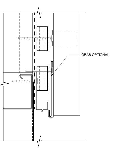
SCUPPER W/ RAINWATER HEAD COMMERCIAL VERTICAL CLADDING
