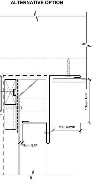
SOFFIT COMMERCIAL VERTICAL CLADDING
